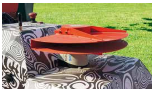
Laserscanner zur Umfeldüberwachung (im Test).
