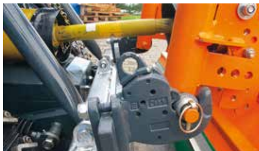
Geräteaufnahme der Kategorie 1 - Standardsystem zum Anbau Ihrer vorhandenen Anbaugeräte.
