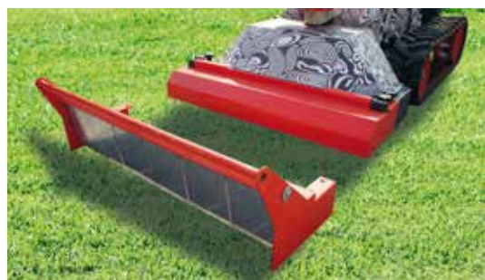
Das twin Mähdeck ermöglicht das Mähen sowohl beim vorwärts als auch beim rückwärts Fahren.
