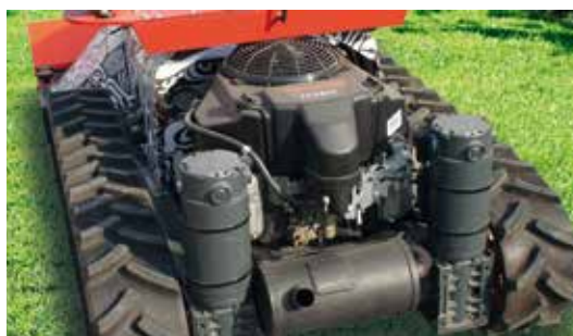
Der Motor mit 16 PS versorgt den RoboFlail twin mit dem nötigen Strom, sowohl für den Antrieb also auch für das Mähdeck.
