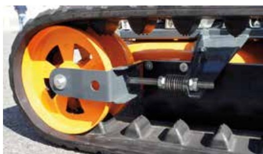
Antriebsräder und Spannräder in Profiausführung mit groß dimensionierten Lagern und Abstreifern.
