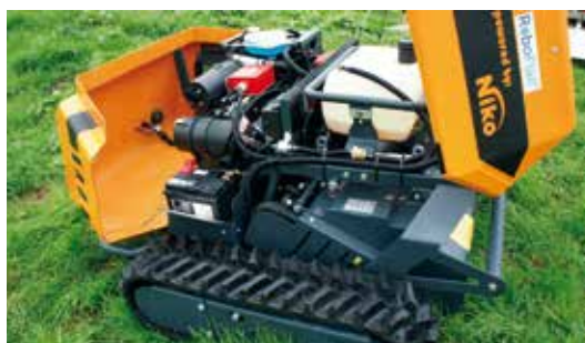
Einfaches Öffnen der Abdeckungen sorgt für einen einfachen Zugang zu den Komponenten.
