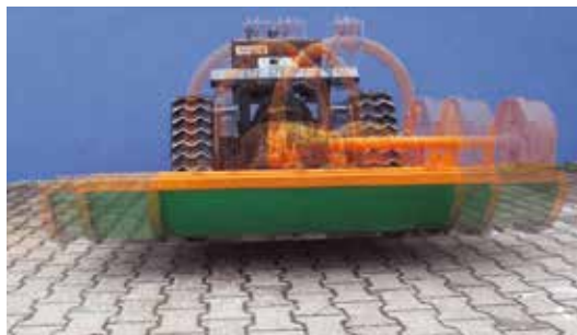
40 cm Seitenverschiebung zum echten randnahen Arbeiten an Zäunen, Treppen und Mauern.
