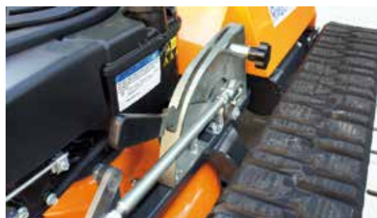
Schnitthöhenverstellung mit integrierter Schwimmstellung und einstellbarer Deckstellung.
