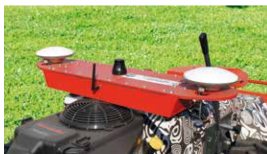
Duale GNSS-Antenne mit einer Genauigkeit von bis zu 2 cm inkl. 3D Terrainkorrektur.
